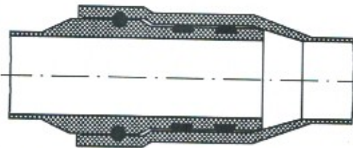
Раструбное, ступенчатое, стопорное с уплотнением круглого сечения (НССК, РССК)
