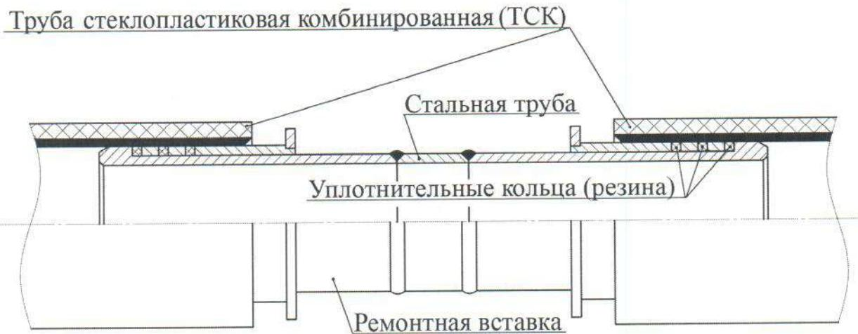
Рисунок 7 –Ремонт с помощью ремонтной вставки
